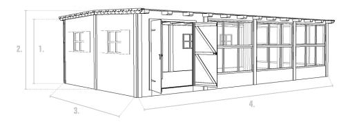
1.Side height:2.22 m2.Centre height:2.50 m3.Extendableper 2.50 m4.Extendableper 2.50 m(min. 5m)
